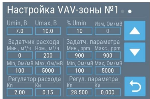
**Задачик расход и Задатчик параметра.** Эти поля настраиваются при наличии ручного регулятора расхода или ручного регулятора параметра:
