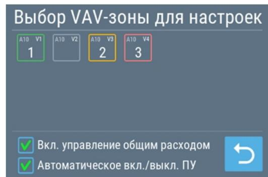
Для наглядности в верхних углах каждой зоны отображаются два параметра, например, для первой зоны A10 и V1. Расшифровываются они следующим образом:
