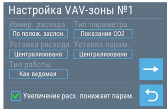
Обратите внимание: при **смешанном** управлении переключение на управление от регулятора производится при повороте его ручки в положение Min и удержании его в этом положении в течении 2 секунд. Также на ручное управление можно перейти с пульта, нажав соответствующую пиктограмму на экране управления VAV-зоной. При изменении расхода воздуха с пульта (по сценарию или вручную) управление автоматически переключается на пульт (если только ручной регулятор не находится в положении Min).
