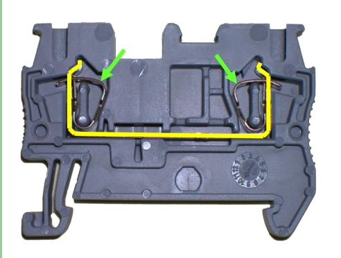
В корпусе клеммы имеется контактная соединительная планка в виде перевернутой буквы «П»
