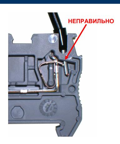
Не допускается вставлять провод в клемму без отжатия пружины отверткой. В этом случае провод не контактирует с соединительной планкой. Создается иллюзия электрического контакта – ток протекает через пружину. И если его значение высокое место контакта провода и пружины, а также пружины и соединительной планки начинает разогреваться, что приводит к разрушению (обогоранию) изоляции клеммы и провода.
