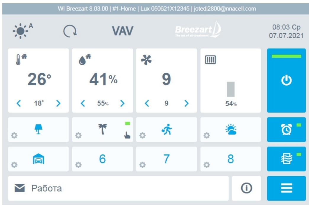
На этой иллюстрации показан Главный экран для приточной установки серии Lux. Для ПВУ дополнительно будет отображаться загрязненность вытяжного фильтра.
