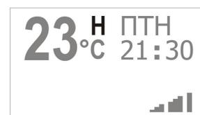
Автоматическое переключение режимов доступно в ПУ, оборудованных датчиком температуры уличного (приточного) воздуха (опция «**Управление Зима/Лето: Авто**»). В этом случае режим работы «Зима» или «Лето» выбирается автоматически на основании температуры приточного воздуха.
