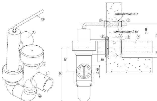
Гидрозатвор рассчитан на максимальное рабочее отрицательное давление в поддоне увлажнителя/охладителя в 800 Па. Если отрицательное давление превышает 800 Па, гидрозатвор необходимо заменить. Гидрозатвор оборудован невозвратным клапаном, который делает его самозаполняющимся (то есть, его не надо заполнять водой перед запуском).
