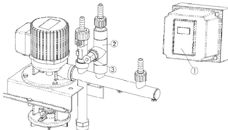
Зонд проводимости вставляется в держатель и с помощью гибкого соединения подключается к датчику.
