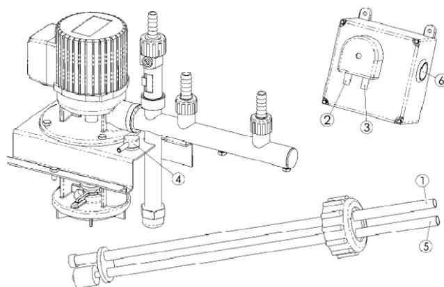
Трубка всасывания крепится на контейнер с биоцидом (контейнер с биоцидом не входит в поставку). Шланг от трубки всасывания подсоединяется к впускному отверстию дозирующего насоса.
