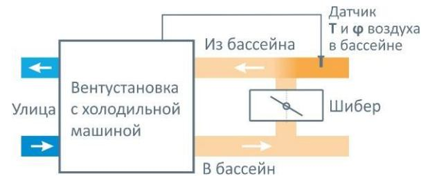
Если воздухопроводная сеть имеет невысокое сопротивление, то фактический расход воздуха может быть выше оптимального значения. В этом случае на этапе пуско-наладки необходимо уменьшить управляющее напряжение на вентиляторе в Рабочем режиме, чтобы фактический расход воздуха был равен оптимальному расходу, указанному в характеристиках. Для Дежурного режима необходимо установить меньшее напряжение (ориентировочно 50% от напряжения для Рабочего режима).
