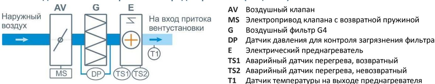
Схема подключения дополнительного электрического нагревателя для преднагрева воздуха на входе в вентустановку (для регионов с холодным климатом). В состав опции PE входит управление преднагревателем, управление приводом клапана, контроль загрязненности фильтра. Электрический преднагреватель приобретается отдельно.
