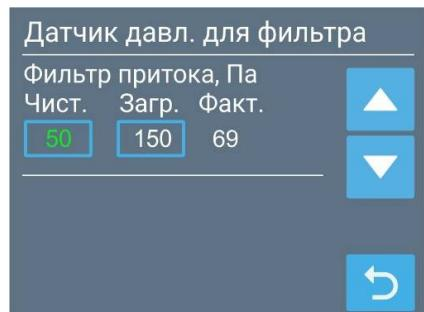
Для вентустановки с двойным фильтром перепад давления измеряется на двух фильтрах сразу, поэтому для такого варианта задаются значения 120 Па для чистых и 250 Па для загрязненных фильтров. Задание этих значений происходит автоматически при установке селектора «Двойной фильтр G4+F7» на экране Меню / Фильтр. При необходимости эти значения можно скорректировать вручную на экране Сервис / Фильтр.
