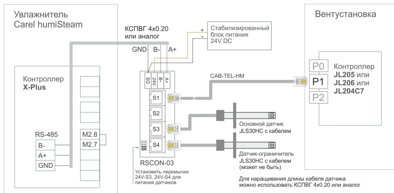
**Внимание!** Если к порту P1 также подключено другое оборудование (например, модуль JL201DPR), то на этом оборудовании необходимо изменить параметры работы ModBus, а именно установить параметр **четность «Нет»** (без контроля четности).
