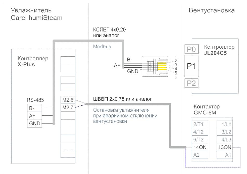
Подключение производится двумя кабелями:
