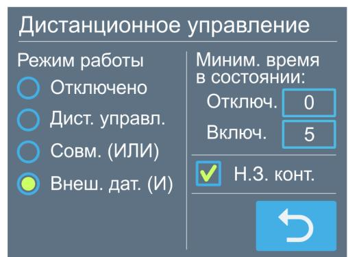
При включенном внешнем управлении могут быть установлены таймеры на минимальное время работы во включенном состоянии и минимальное время нахождения в выключенном состоянии. Таймеры могут использоваться при управлении вентустановкой импульсным сигналом, который подается в течение короткого промежутка времени.
