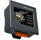
За дополнительную оплату возможно применение панели VPD-173N <https://ipc2u.ru/catalog/vpd-173n> (поставка под заказ 4 недели) в качестве второго пульта, с которого можно управлять только пользовательскими функциями (сервисные настройки – с основного штатного пульта, располагаемого за пределами помещения бассейна, например, в венткамере).
