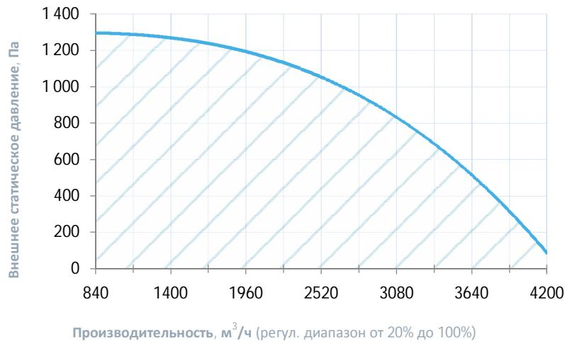
\* На вентхарактеристике указана производительность приточного канала. Производительность вытяжного канала может регулироваться от 70% до 120% приточного канала. КПД рекуператора показано для соотношения расходов воздуха 1:1.
