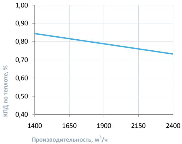
\* На вентхарактеристике указана производительность приточного канала. Производительность вытяжного канала может регулироваться от 70% до 120% приточного канала. КПД рекуператора показано для соотношения расходов воздуха 1:1.
