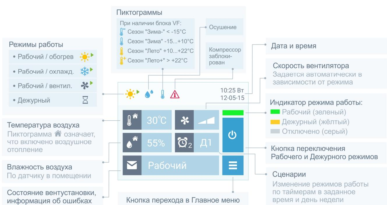
В верхней строке экрана расположены пиктограммы, показывающие режим работы и состояние вентустановки. Иконка «Компрессор заблокирован» появляется в режиме охлаждения при слишком высокой температуре воздуха внутри или снаружи помещения, либо если температура воздуха в помещении опустилась ниже 23°C.
