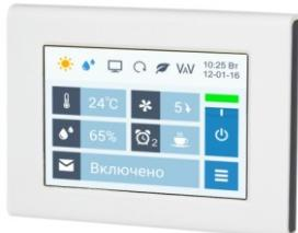
Пульт JLV135 выполнен в накладном корпусе и имеет цветной сенсорный экран емкостного типа. Диагональ экрана 3,5", разрешение 480 x 320 точек, встроенный Wi-Fi модуль. Может использоваться в качестве штатного пульта управления совместно с вентустановками Breezart, выпускаемыми с июня 2021 года. Для подключения к вентустановке требуется специальный кабель CAB-JLV-15 (длина 15 метров, поставляется в комплекте) или CAB-JLV-30 (длина 30 метров, под заказ).
