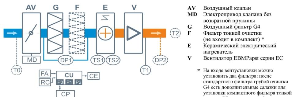
\* На входе вентустановки можно установить два фильтра: после стандартного фильтра грубой очистки G4 есть дополнительные салазки для установки компактного фильтра тонкой очистки F7 или угольного фильтра.
